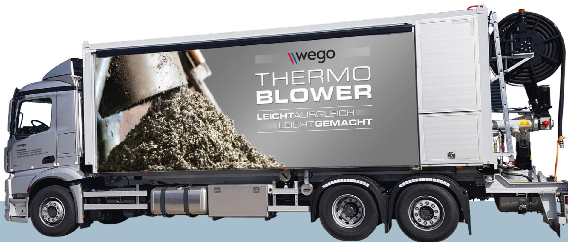
Der wego Thermo Blower dient zur Herstellung von gebundenen Ausgleichsschüttungen gemäß DIN 18560-2 und ermöglicht den Ausgleich von Installationsebenen sowie Unebenheiten. Durch die mögliche Einstellung unterschiedlicher Festigkeiten eignet sich der Leichtausgleich sowohl für den Einsatz unter klassischen Estrichen als auch unter Trockenestrichen und Dünnschichtsystemen.
